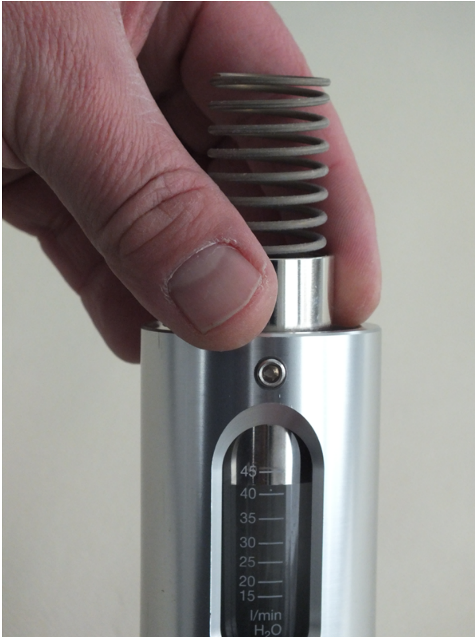
Abb. 55: Schwebekörper und Innenteile einführen
