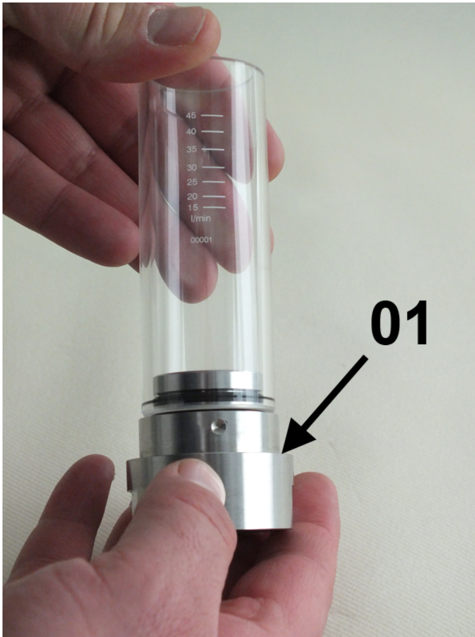
Abb. 50: Verschraubung (Eingang) in Schauglas
