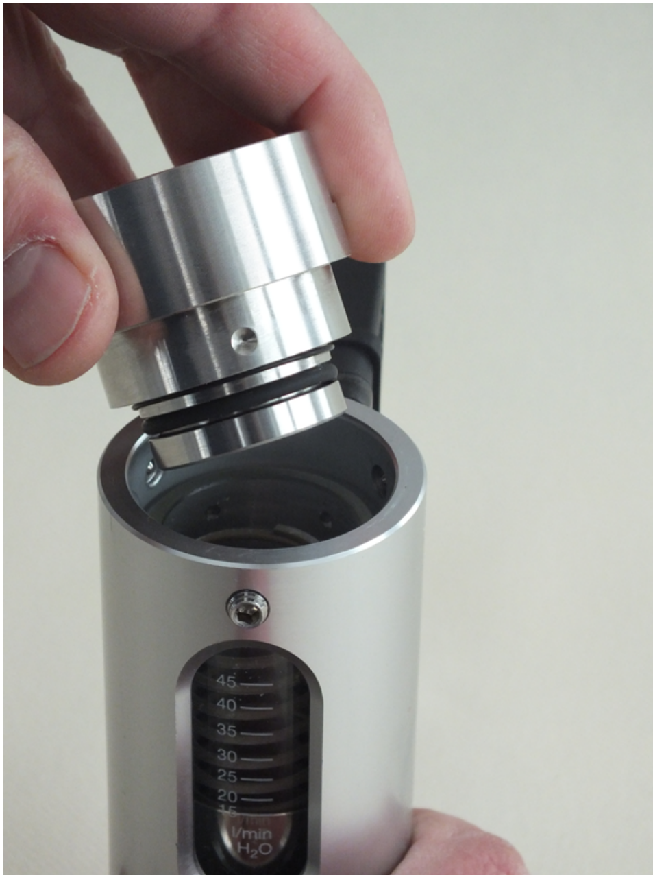
Abb. 42: Verschraubung (Ausgang) abnehmen
