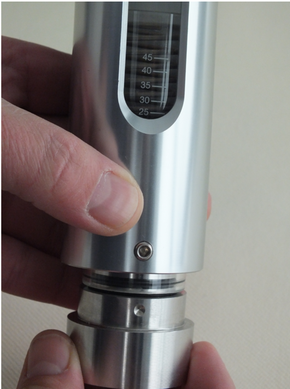
Abb. 52: Verschraubung in Gerätehülse schieben
