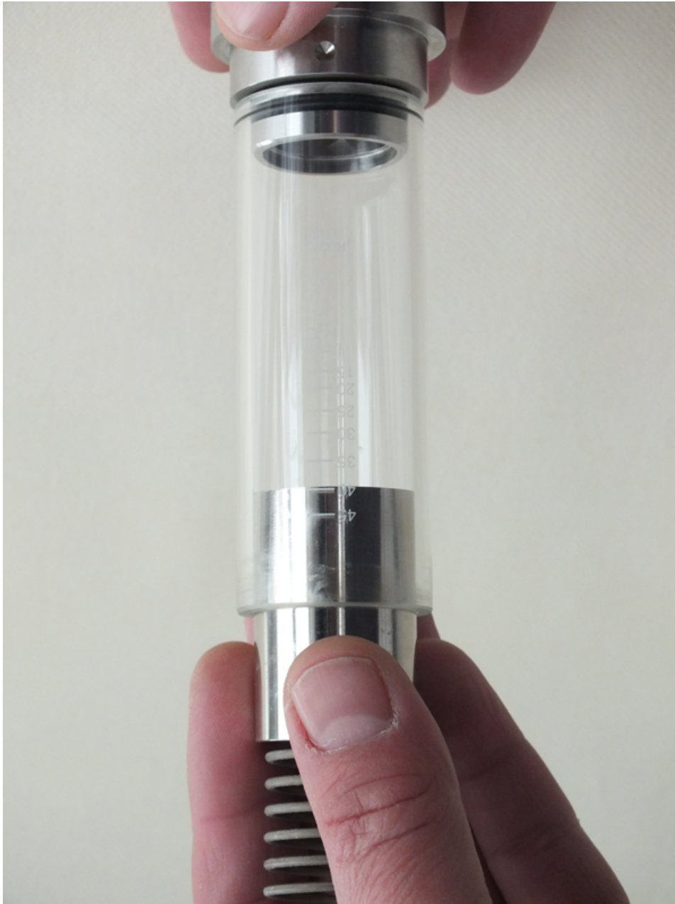
Abb. 45: Schwebekörper, Magnete und Feder entnehmen
