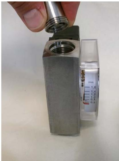
Abb. 45: Gewinding (Ausgang) entnehmen
