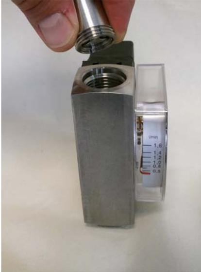
Abb. 56: Gewinding (Ausgang) einführen
