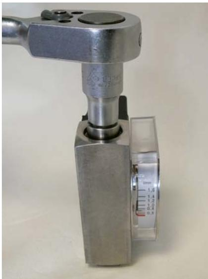
Abb. 44: Gewinding (Ausgang) lösen
