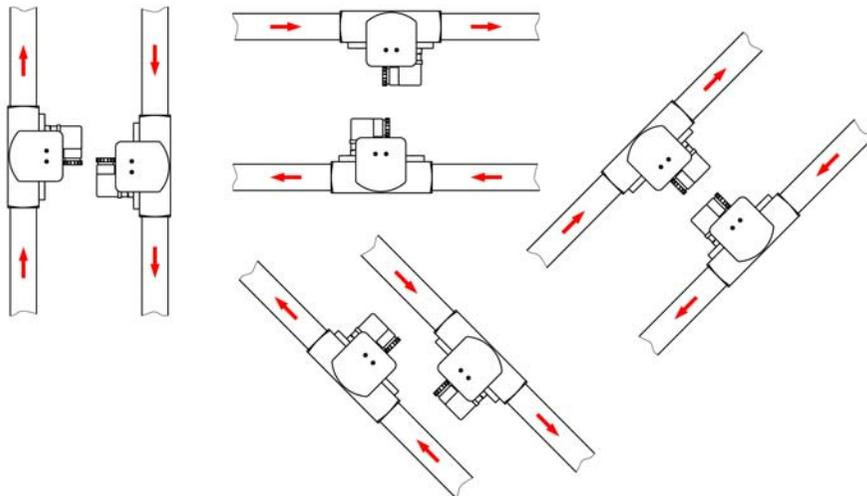
*Abb. 6: Einbauposition/Durchflussrichtung*
