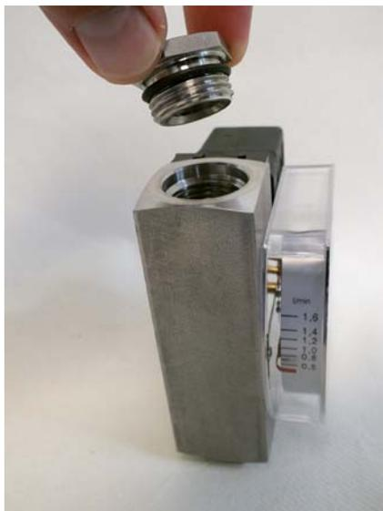
*Abb. 58: Verschraubung (Ausgang) einsetzen*
