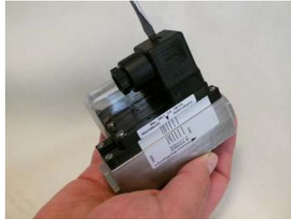
Abb. 21: Steckerdose lösen
