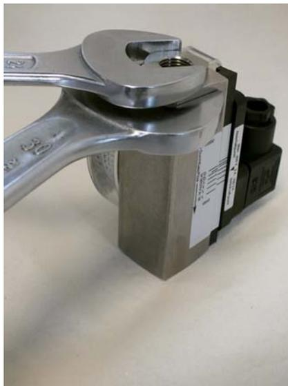
Abb. 53: Verschraubung (Eingang) festziehen
