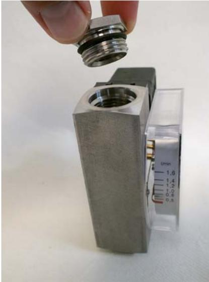
Abb. 42: Verschraubung (Ausgang) abnehmen
