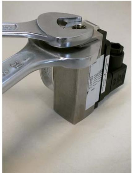
Abb. 48: Verschraubung (Eingang) lösen
