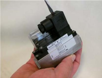
Abb. 66: Steckerdose lösen
