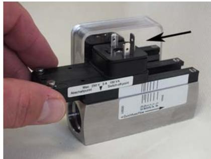
Abb. 69: Schaltkontakt aus Führung schieben
