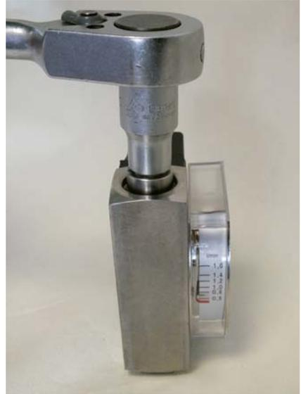
Abb. 57: Gewinding (Ausgang) festziehen
