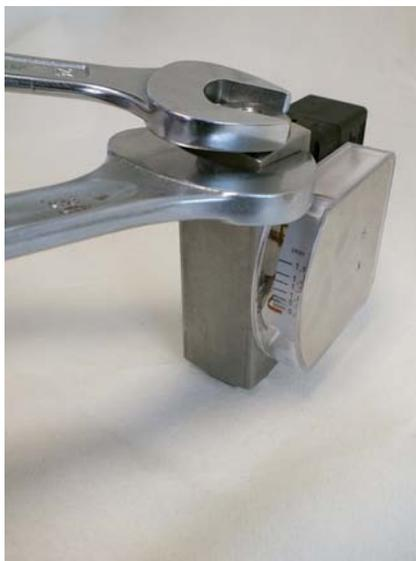
*Abb. 59: Verschraubung (Ausgang) festziehen*
