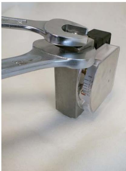
Abb. 41: Verschraubung (Ausgang) lösen
