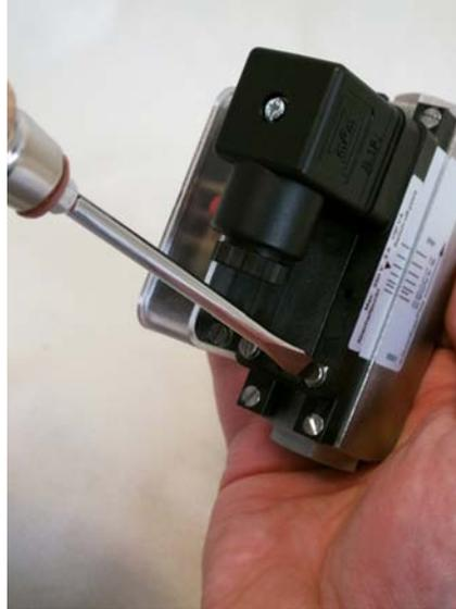
Abb. 68: Feststellschrauben lösen
