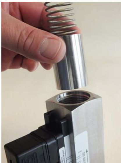
Abb. 55: Innenteile einführen
