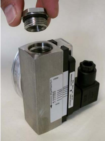
Abb. 49: Verschraubung (Eingang) abnehmen
