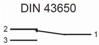
Abb. 16: Zustand des Kontaktes bei Gerät ohne Durchfluss
