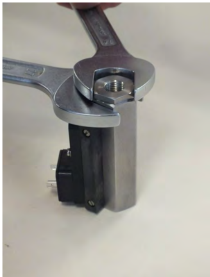
Abb. 43: Verschraubung (Eingang) lösen
