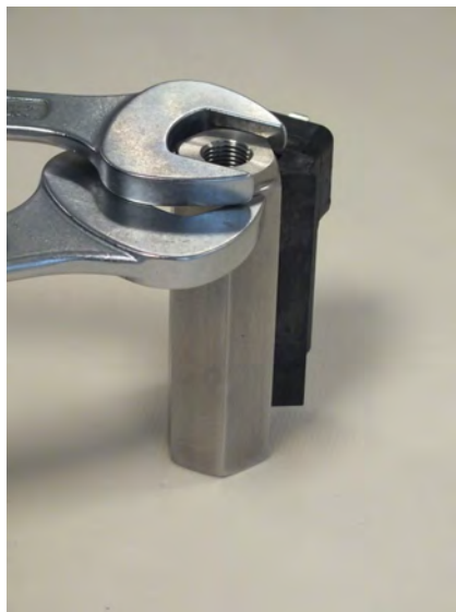
Abb. 36: Verschraubung (Ausgang) lösen
