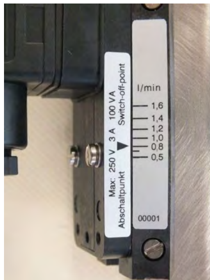
Abb. 35: Schaltwert ablesen (Beispiel-skala)
