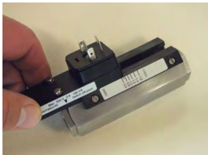
Abb. 59: Schaltkontakt aus Führung schieben
