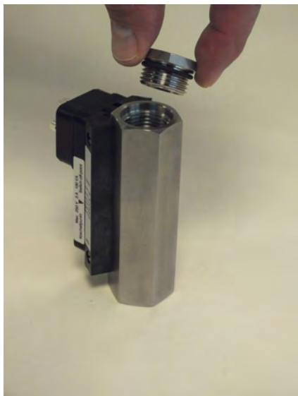
Abb. 53: Verschraubung (Ausgang) einsetzen
