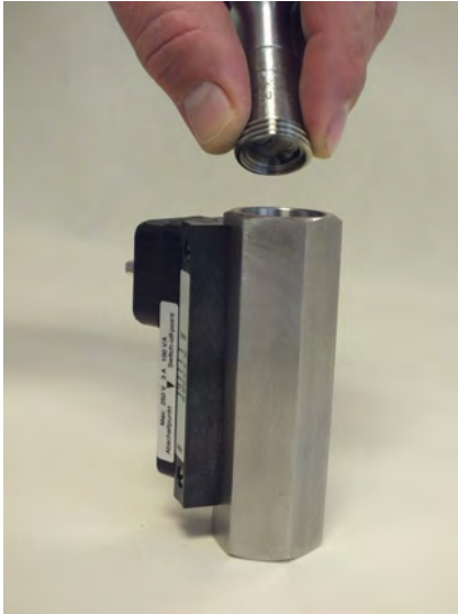
Abb. 40: Gewinding (Ausgang) entnehmen
