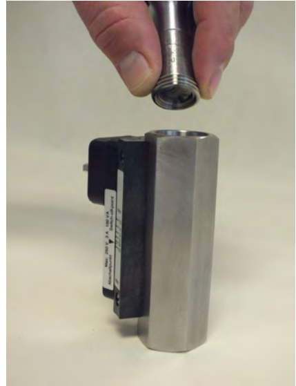
Abb. 51: Gewinding (Ausgang) einführen
