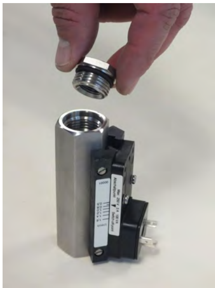
Abb. 47: Verschraubung (Eingang) einsetzen
