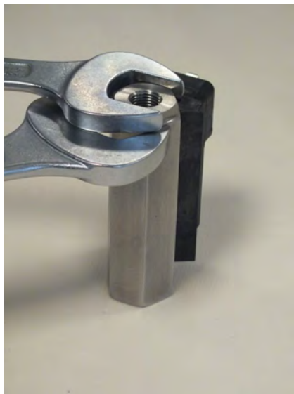
Abb. 54: Verschraubung (Ausgang) festziehen
