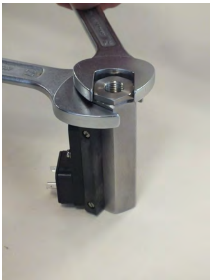
Abb. 48: Verschraubung (Eingang) festziehen
