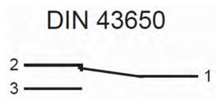
Abb. 15: Zustand des Kontaktes bei Gerät ohne Durchfluss
