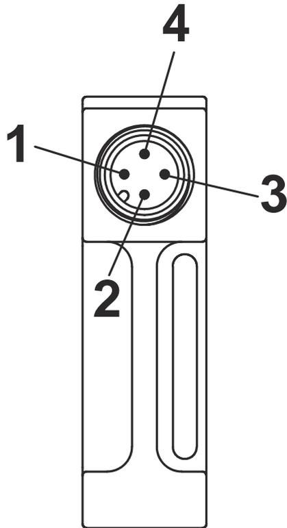
Abb. 16: Pin-Belegung Gerätestecker M12x1 (Form 15x50)
