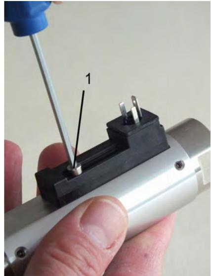
Abb. 54: Feststellschraube lösen
