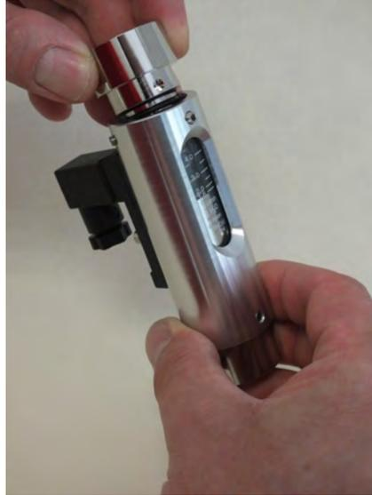
*Abb. 35: Verschraubung (Ausgang) abnehmen*
