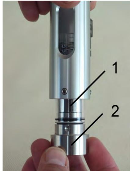
Abb. 37: Innenteile herausziehen
