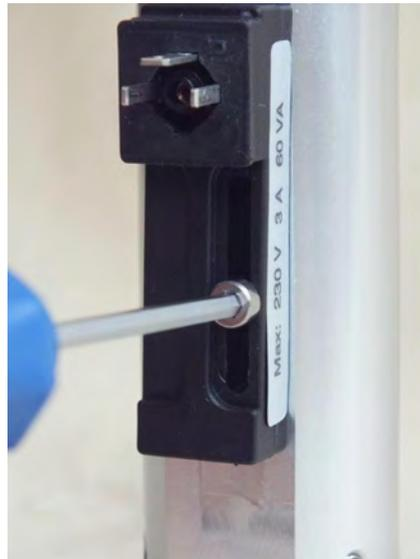
Abb. 31: Feststellschraube lösen
