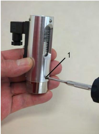
Abb. 36: Schrauben lösen
