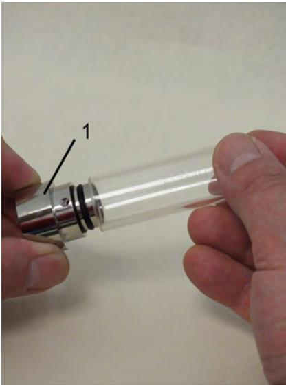
Abb. 43: Verschraubung (Eingang) in Schauglas
