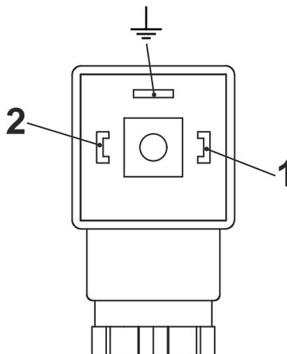
*Abb. 13: Pin-Belegung Steckerdose Schließer (Erde-Anschluss nicht genutzt)*
