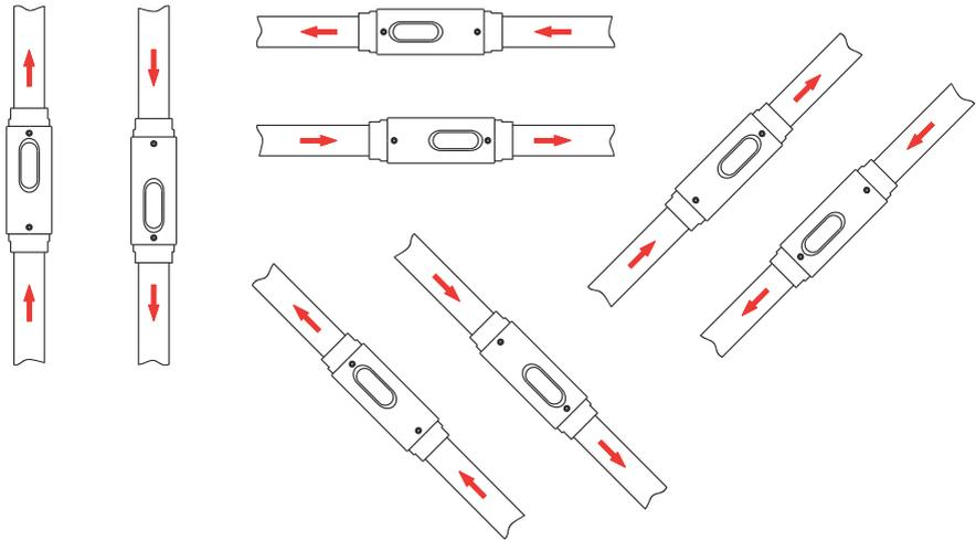
Abb. 5: Einbauposition/Durchflussrichtung
