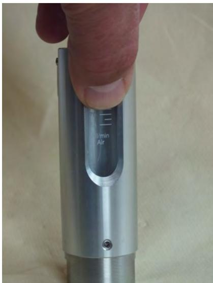
Abb. 47: Schauglas ausrichten
