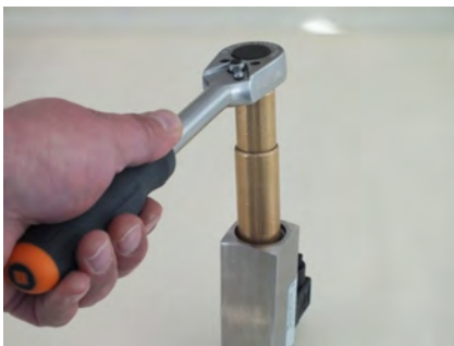
Abb. 46: Gewindering (Eingang) lösen
