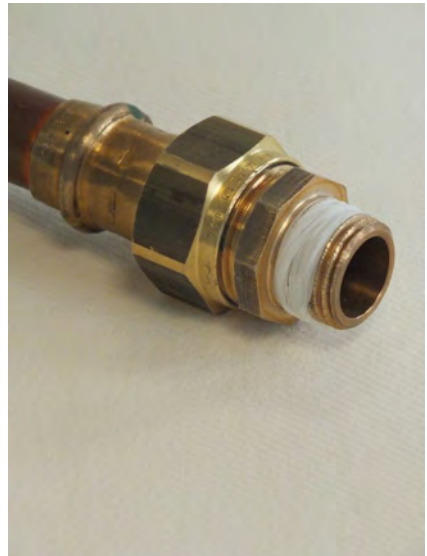
Abb. 10: Rohrleitung mit Dichtfaden
