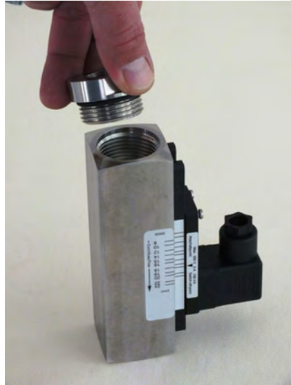
Abb. 52: Verschraubung (Eingang) einsetzen
