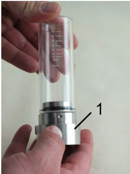
Abb. 44: Verschraubung (Eingang) in Schauglas
