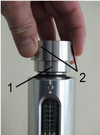
Abb. 50: Verschraubung (Ausgang) in Gerätehülse einsetzen
