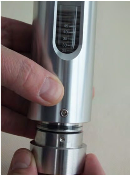
Abb. 46: Verschraubung in Gerätehülse schieben
