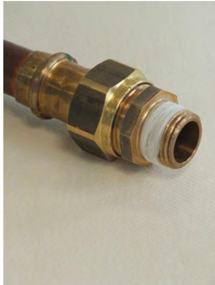
Abb. 10: Rohrleitung mit Dichtfaden
