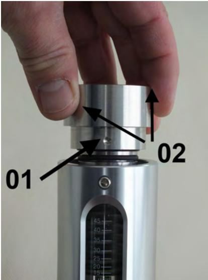
Abb. 51: Verschraubung (Ausgang) in Gerätehülse einsetzen
