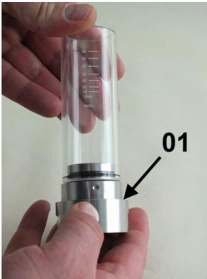
Abb. 45: Verschraubung (Eingang) in Schauglas
