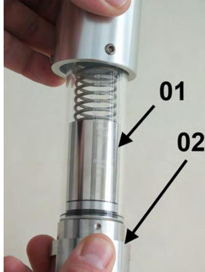
Abb. 39: Innenteile herausziehen
