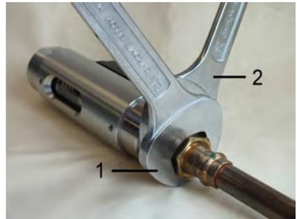
Abb. 12: Gerät einschrauben
