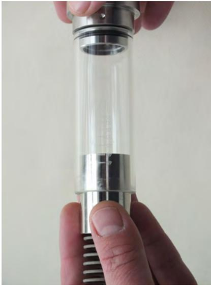
Abb. 40: Schwebekörper, Magnete und Feder entnehmen
