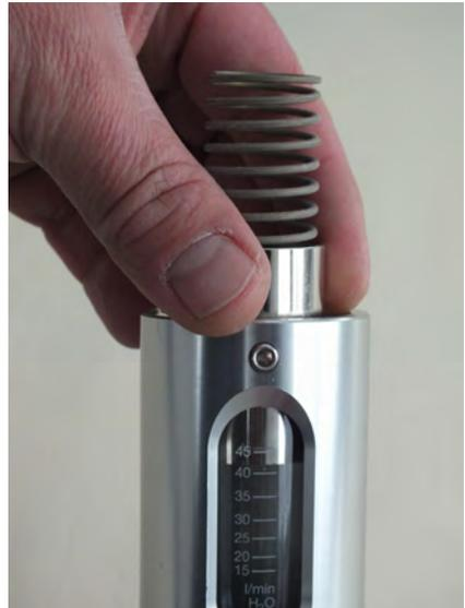
*Abb. 50: Innenteile einführen*
