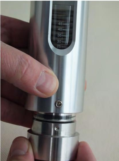
Abb. 47: Verschraubung in Gerätehülse schieben
