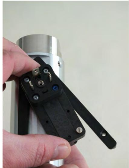
Abb. 58: Führungsleiste wegklappen
