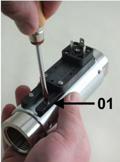
Abb. 57: Führungsleiste lösen
