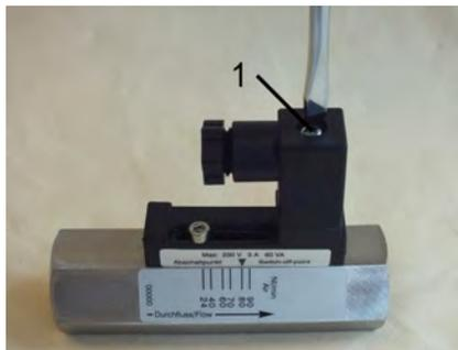
Abb. 20: Steckerdose lösen
