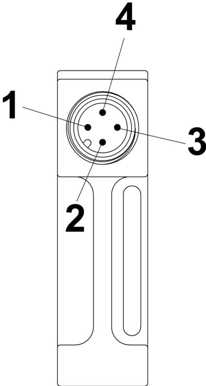
Abb. 16: Pin-Belegung Gerätestecker M12x1 (Form 15x50)
