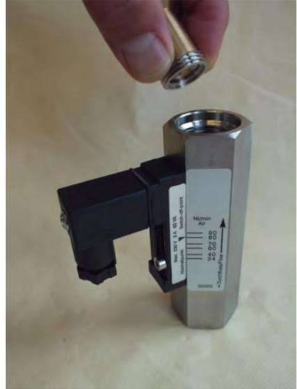
Abb. 36: Gewinding (Ausgang) entnehmen
