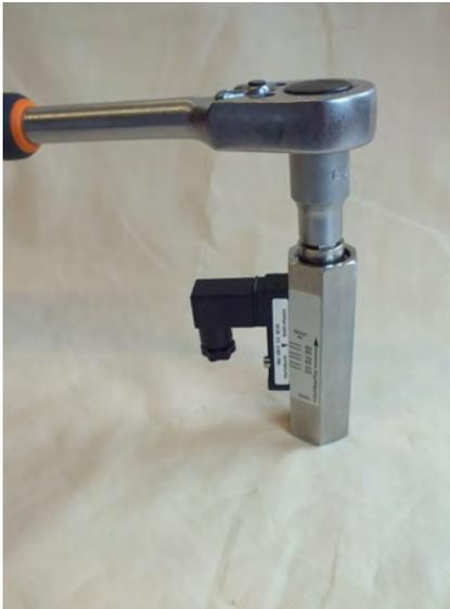
Abb. 41: Gewinding (Ausgang) festziehen
