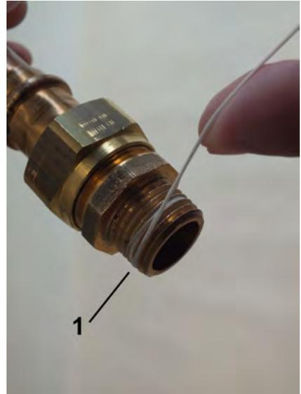
Abb. 8: Dichtfaden aufbringen
