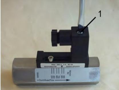
Abb. 43: Steckerdose lösen
