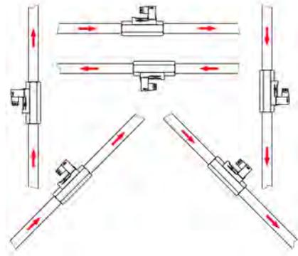
Abb. 5: Einbauposition/Durchflussrichtung
