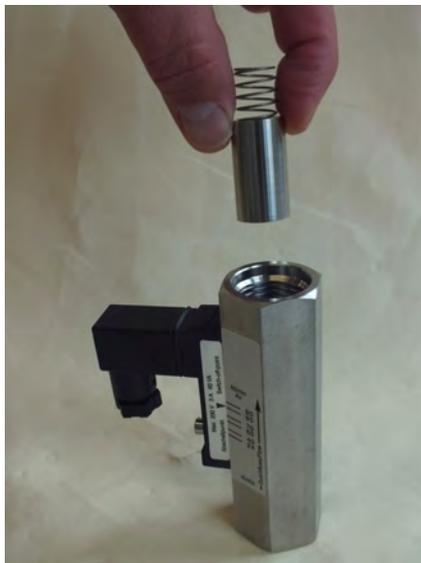
Abb. 39: Innenteile einführen
