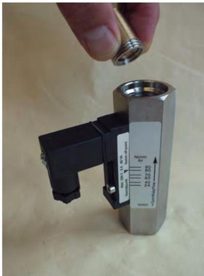
Abb. 40: Gewinding (Ausgang) einführen
