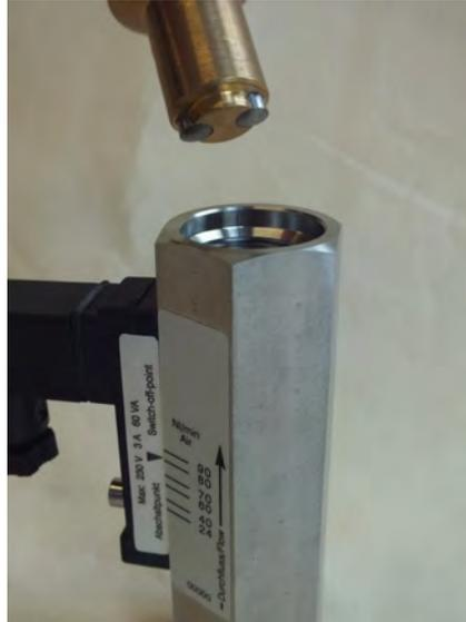
Abb. 34: Eindrehwerkzeug-Gewindering einführen (Ausgang)
