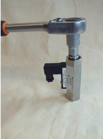
Abb. 35: Gewinding (Ausgang) lösen
