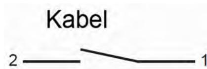
Abb. 19: Zustand des Kontaktes bei Gerät ohne Durchfluss
