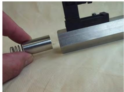
Abb. 37: Innenteile entnehmen
