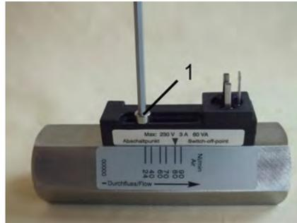
Abb. 45: Feststellschraube lösen
