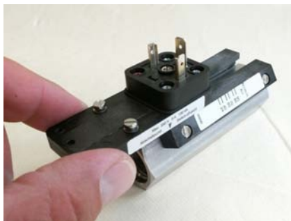
Abb. 46: Schaltkontakt aus Führung schieben
