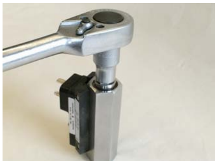
Abb. 41: Gewinding (Ausgang) festziehen
