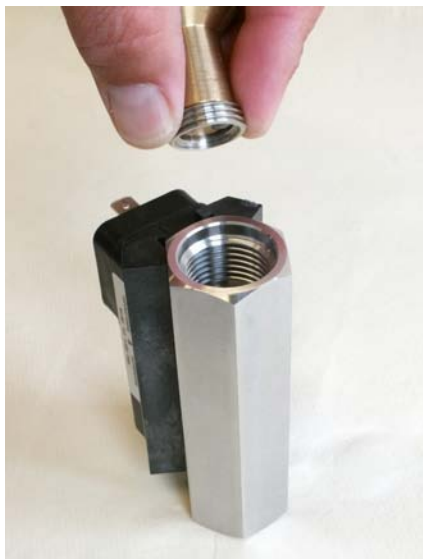
Abb. 35: Gewinding (Ausgang) entnehmen
