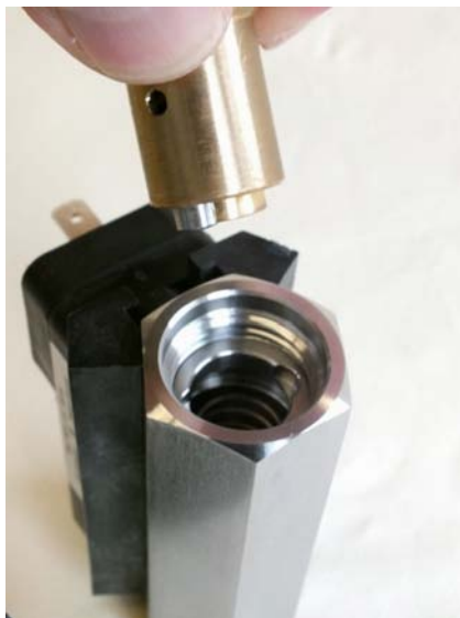
Abb. 33: Eindrehwerkzeug-Gewindingering einführen (Ausgang)
