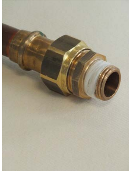
Abb. 9: Rohrleitung mit Dichtfaden
