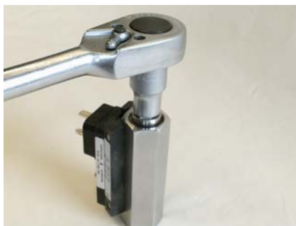
Abb. 34: Gewindingering (Ausgang) lösen
