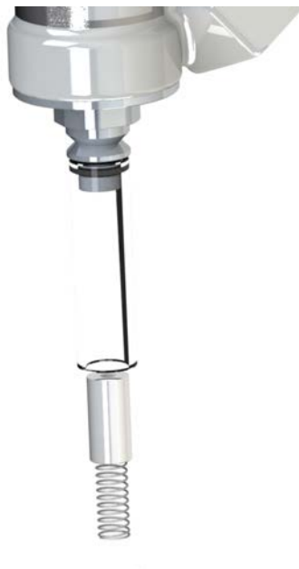
Abb. 38: Durchflussanzeiger, Magnete und Feder entnehmen
