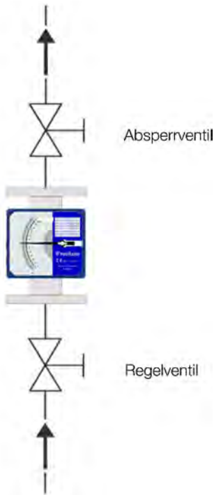
Abb. 12: Ventilpositionen wenn Ausgangsdruck gleich dem Kalibrierdruck
