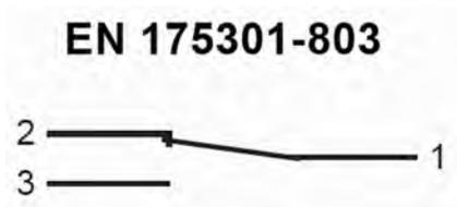
Abb. 15: Zustand des Kontaktes bei Gerät ohne Durchfluss
