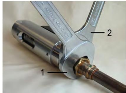
Abb. 12: Gerät einschrauben
