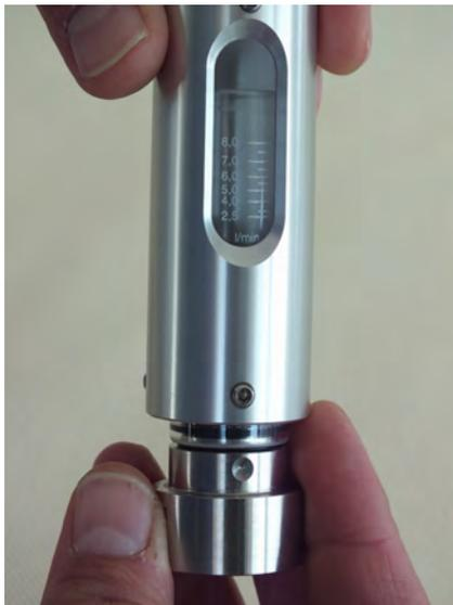
Abb. 46: Verschraubung in Gerätehülse schieben
