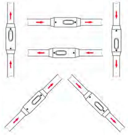
Abb. 5: Einbauposition/Durchflussrichtung
