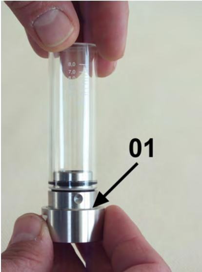
Abb. 44: Verschraubung (Eingang) in Schauglas
