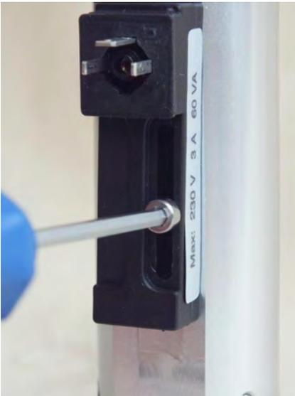
Abb. 33: Feststellschraube lösen
