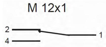
Abb. 19: Zustand des Kontaktes bei Gerät ohne Durchfluss
