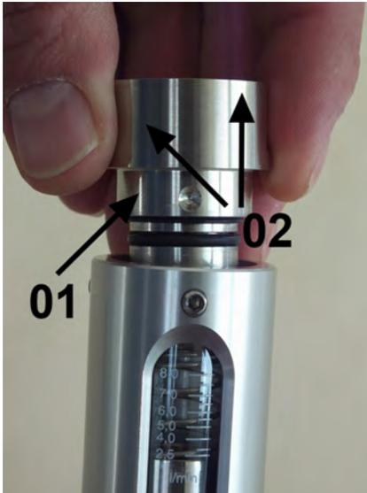
Abb. 50: Verschraubung (Ausgang) in Gerätehülse einsetzen
