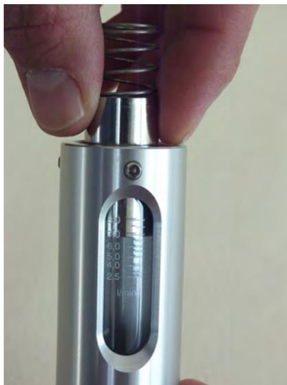
Abb. 49: Schwebekörper und Innenteile einführen
