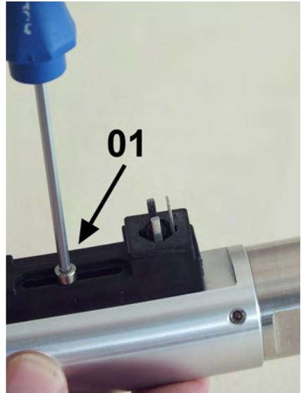
Abb. 55: Feststellschraube lösen
