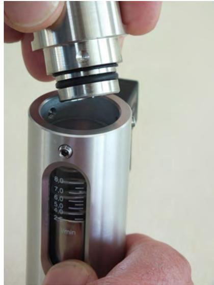
Abb. 36: Verschraubung (Ausgang) abnehmen
