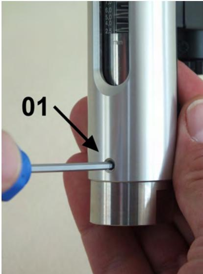
Abb. 37: Schrauben lösen
