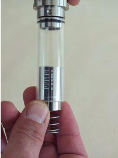
Abb. 39: Schwebekörper, Magnete und Feder entnehmen
