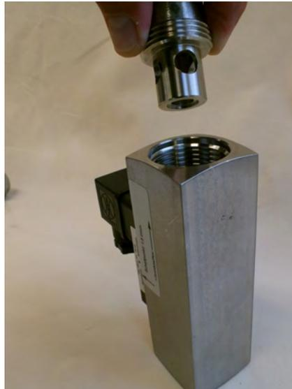
Abb. 47: Gewinding (Ausgang) einführen
