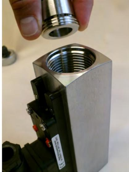
Abb. 42: Gewinding (Eingang) entnehmen
