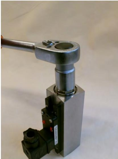
Abb. 44: Gewinding (Eingang) festziehen
