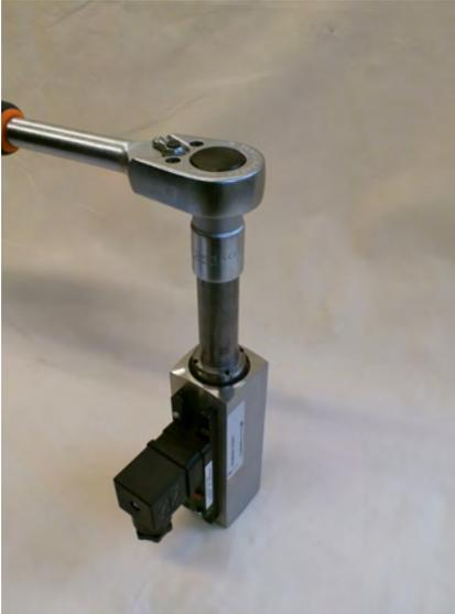
Abb. 48: Gewinding (Ausgang) festziehen
