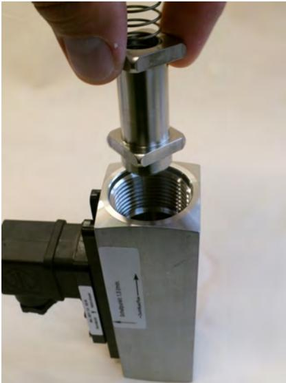
Abb. 46: Innenteile einführen
