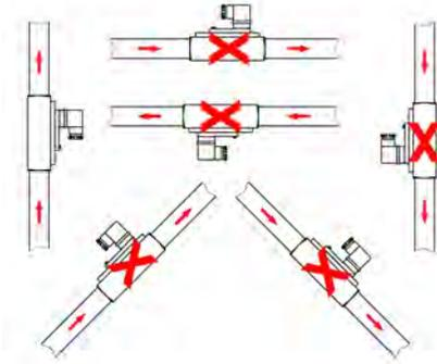
Abb. 5: Einbauposition/Durchflussrichtung
