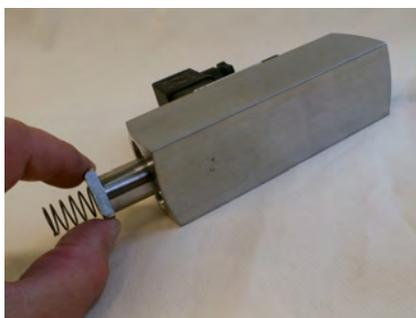
Abb. 38: Innenteile entnehmen
