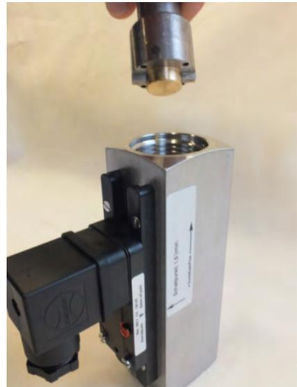
*Abb. 35: Eindrehwerkzeug-Gewindering einführen (Ausgang)*
