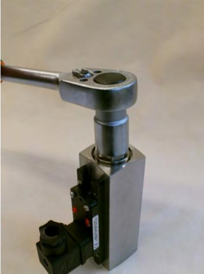
Abb. 41: Gewinding (Eingang) lösen
