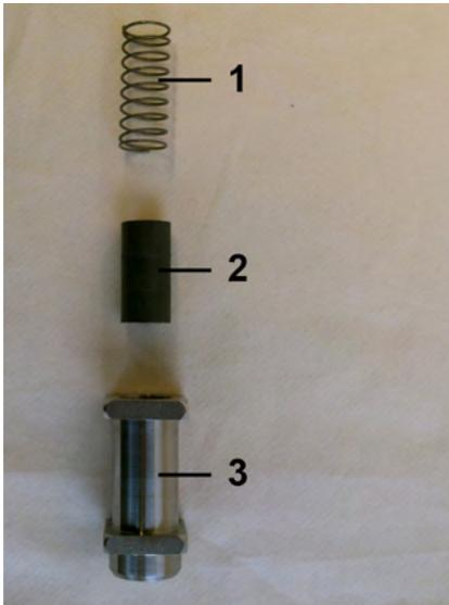
Abb. 39: Feder, Magnete und Schwebekörper
