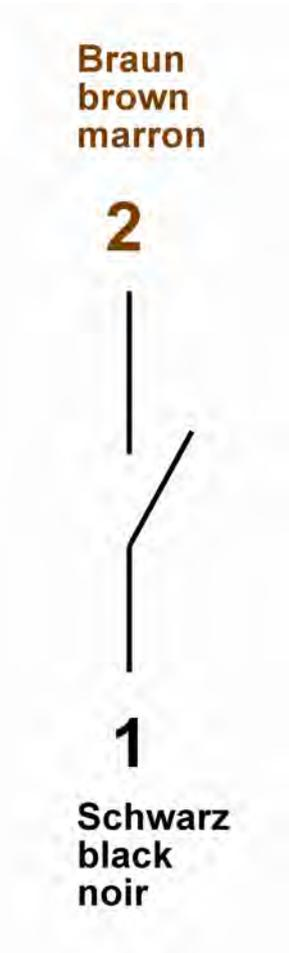
*Abb. 20: Zustand des Kontakts bei Gerät ohne Durchfluss*
