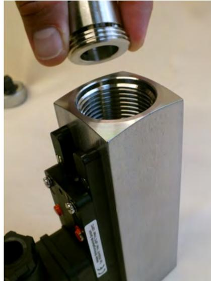
Abb. 43: Gewinding (Eingang) einführen
