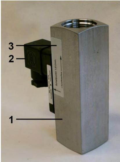
In dem Strömungswächter befindet sich ein Schwebekörper, der durch das durchfließende Medium bewegt wird. Durch die im Schwebekörper integrierten Magnete wird ein Magnetfeld erzeugt. Die Position des Schwebekörpers wird durch den Schaltkontakt ermittelt. Der kundenspezifische Schaltpunkt wird werkseitig eingestellt.
