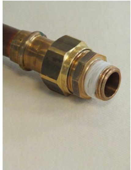
Abb. 10: Rohrleitung mit Dichtfaden
