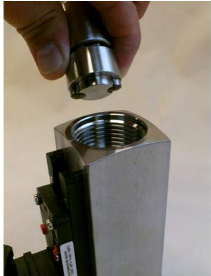
Abb. 40: Eindreihwerkzeug Gewindering (Eingang) einführen
