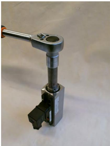
Abb. 36: Gewinding (Ausgang) lösen
