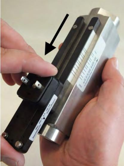
Abb. 67: Schaltkontakt aus Führung schieben
