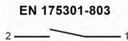
Abb. 13: Zustand des Kontakts bei Gerät ohne Durchfluss
