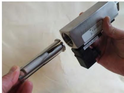
Abb. 45: Innenteile entnehmen
