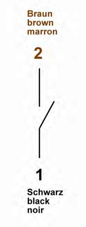
Abb. 20: Zustand des Kontakts bei Gerät ohne Durchfluss
