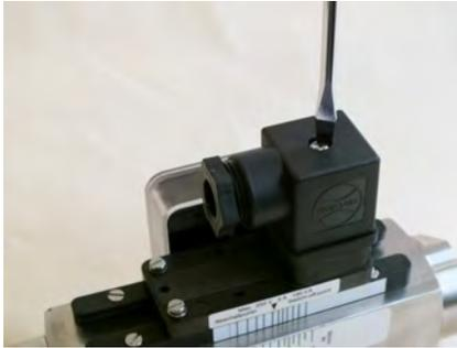
Abb. 64: Steckerdose lösen
