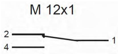
Abb. 19: Zustand des Kontakts bei Gerät ohne Durchfluss
