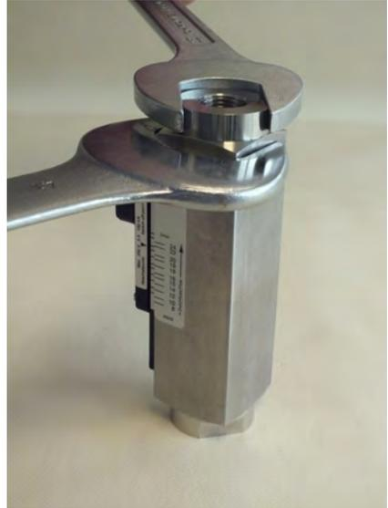
Abb. 57: Verschraubung (Ausgang) festziehen
