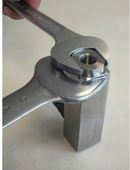
Abb. 52: Verschraubung (Eingang) festziehen
