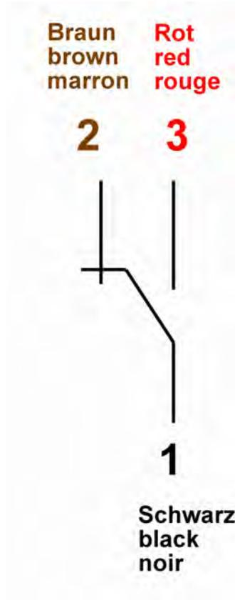
Abb. 21: Zustand des Kontakts bei Gerät ohne Durchfluss
