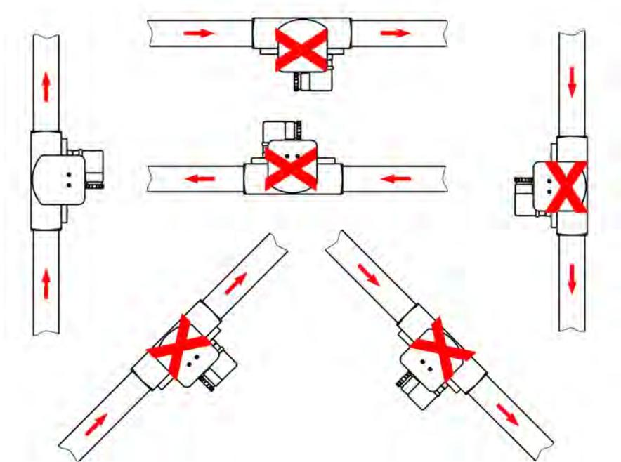
*Abb. 6: Einbauposition/Durchflussrichtung*
