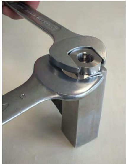
Abb. 47: Verschraubung (Eingang) lösen
