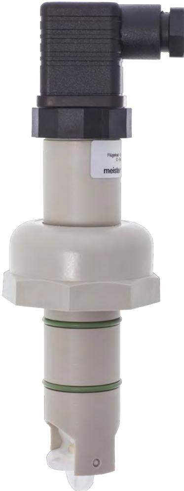
Die Durchflussmesser der Baureihe DHTF messen den Durchfluss mit einem Flügelrad, das mit Magneten bestückt ist. Die Drehzahl des Flügelrades wird mit einem Hall-Sensor abgetastet und von der integrierten Elektronik in auswertbare Impulse umgewandelt.
